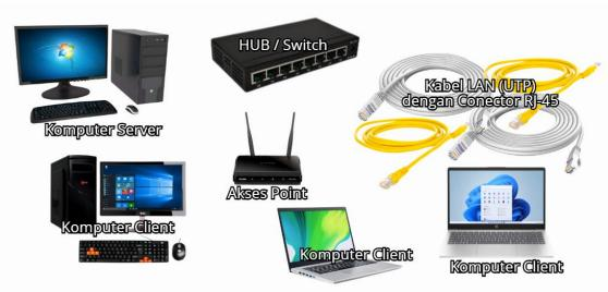
Gambar 371: Gambar perangkat yang diperlukan untuk membangun LAN
